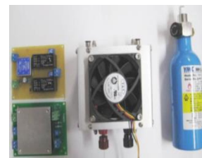
▲燃料電池システム
